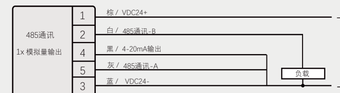
电路接线图-模拟量4-20mA输出+1点开关量
